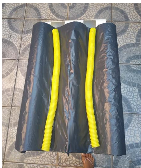
Figura 4 – Conduítes de Escoamento
